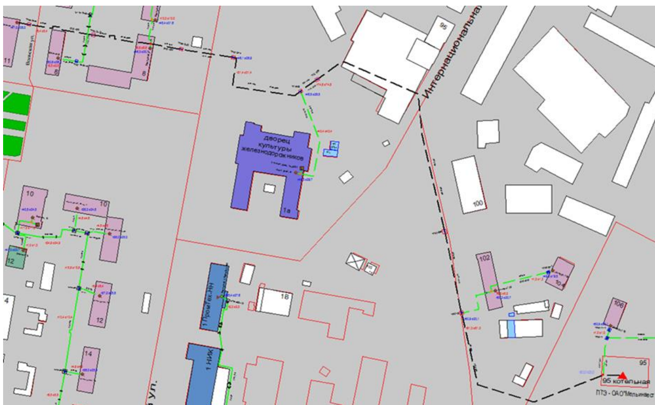
Рисунок 3.119 – Трассировка теплопровода от котельной ОАО «Мельинвест» по ул. Интернациональная, д. 95 до конечного потребителя «ПТ-Вольск,11»
